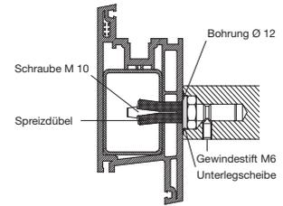
Montageset mit selbstschneidendem Gewinde für Kunststoff- und Metalltüren
