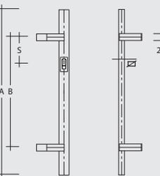
Türgriffe aus Edelstahl, feinmatt poliert, Profil 50 x 20 mm, Höhe (H) 80 mm, Ausladung (C) 130 mm, **mit 45° Stützen 25 x 25 mm**, Länge (A) ... mm, Befestigungsabstand (B) ... mm, Fräsung ekey, Idencom oder Sommer ..., Maß (S) von Mitte obere Stütze bis Mitte Scanner ... mm (Mindestmaß 50 mm), Kabelausgang obere oder untere Stütze ..., Griff rechts- oder linkszeigend ...
