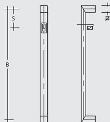
Türgriffe aus Edelstahl, feinmatt poliert, Profil 50 x 20 mm, Höhe (H) 70 mm, **Enden auf Gehrung**, Befestigungsabstand (B) ... mm, Fräsung ekey, Idencom oder Sommer..., Maß (S) von Mitte obere Stütze bis Mitte Scanner ... mm, Kabelausgang obere oder untere Stütze ...
