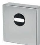
ZRP 52.9.15 Ziehschutzrosettenpaar aus Edelstahl zur Verschraubung von innen mit Senkschrauben M5, Höhe (H) 15 mm für Zylindervorstand 8 - 11 mm.
