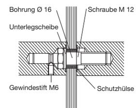
Montageset zur paarweisen Befestigung für Holz-, Kunststoff- und Metalltüren
