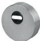
ZRP 52.5.15 Ziehschutzrosettenpaar aus Edelstahl mit korrosionsgeschützten Stahlunterteilen zur Verschraubung von innen mit Senkschrauben M5, Höhe (H) 15 mm für Zylindervorstand 8 - 11 mm.
