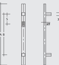
Türgriffe aus Edelstahl, feinmatt poliert, Profil 50 x 20 mm, Höhe (H) 70 mm, **mit geraden Stützen 30 x 30 mm**, Länge (A) ... mm, Befestigungsabstand (B) ... mm, Fräsung ekey, Idencom oder Sommer ... , Maß (S) von Mitte obere Stütze bis Mitte Scanner ... mm Mindestmaß 50 mm), Kabelausgang obere oder untere Stütze ...
